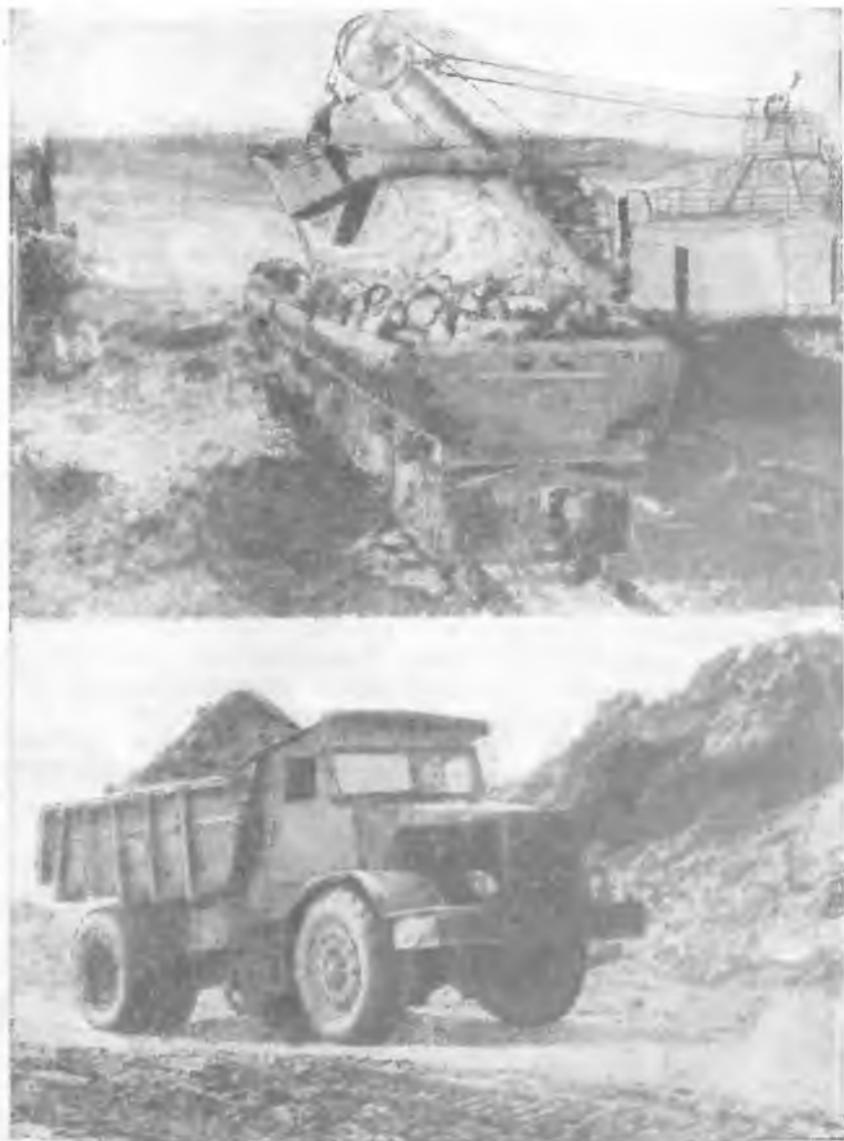
Рис. 12. Перевозка руды — на обогатительную фабрику и «вскрышных пород — в отвал производится железнодорожным и автомобильным транспортом с использованием: самоопрокидывающихся вагонов грузоподъемностью 80—100 т (на верхнем рисунке); автосамосвалов МАЗ-525 грузоподъемностью 25 т (на нижнем рисунке).
