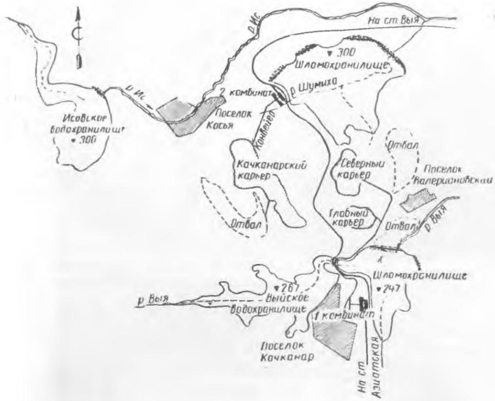
Рис. 6. Схема расположения промобъектов и сооружений качканарских ГОКов.
